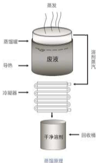
图 2.3.1-1 本项目蒸馏原理示意图
